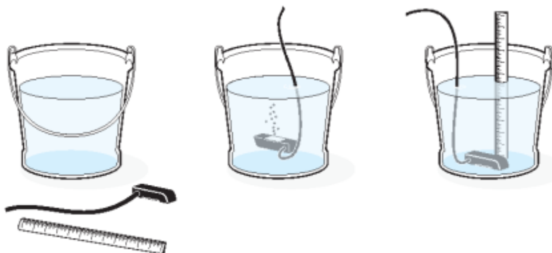
图 18 校准浸入式面积/速率传感器
